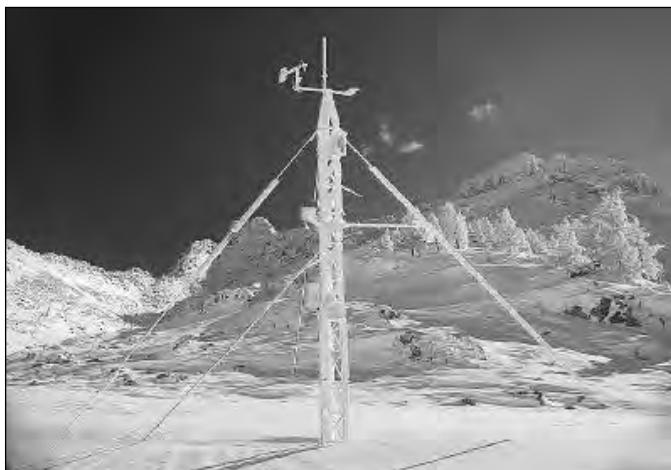
FIGURA 4. Estació nivometeorològica automàtica situada a la Bonai-gua (2.200 m). Aquestes estacions permeten un seguiment continuat de l'evolució dels paràmetres d'interès.
